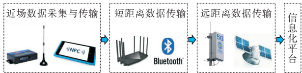
图 1 基于移动互联网数据传输体系
