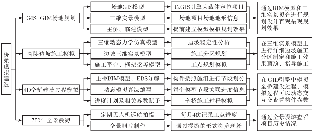
图 4 桥梁虚拟建造功能架构
