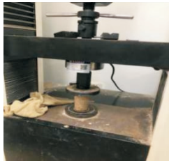
图 2 无侧限压力仪
