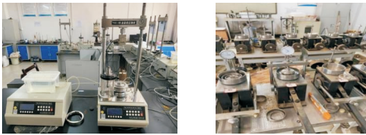
(a) 单杠杆式固结仪 (b) TSZ-2型应变式三轴仪
