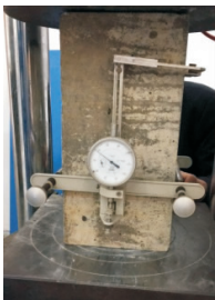
图 1 弹性模量试验装置
