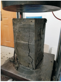
图 3 KB-40 混凝土试件破坏形态
