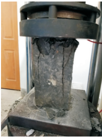
图 4 KB 混凝土试件破坏形态
