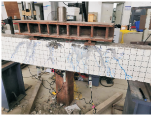
图 4 FRP 筋钢纤维混凝土梁的破坏形态
