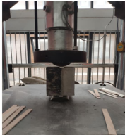
图 4 劈裂拉伸试验
