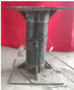
图 3 试件破坏图
