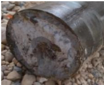
图 1 销轴断裂截面
