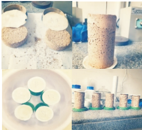
图 5 部分拆模后的试样
