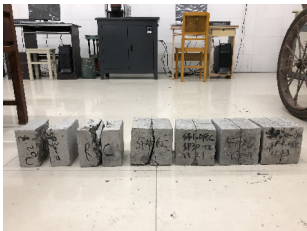
图 6 各配合比试样劈裂抗拉破坏形态对比
