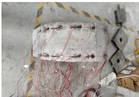
图 4 混凝土应变片布置图
