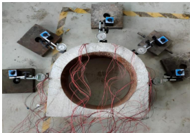
图 5 管道外壁径向位移布置图
