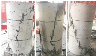
图 3 钢纤维混凝土圆柱体破坏形态
