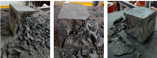
(a)普通混凝土 (b)GF混凝土 (c)AR混凝土
