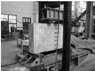
图 2 深梁跨中截面的应变片布置
