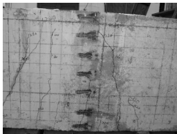
图 5 试件 DBP-3 弯曲破坏裂缝图
