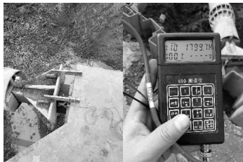
图 7 光谷大道南延线基坑工程轴力计测读
