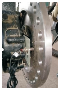
图2 传感器的安装
